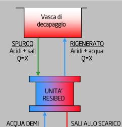
L'IMPIANTO HA UNA STRUTTURA MODULARE ED È COSTITUITO DA UNA SERIE DI LETTI EQUIVALENTI.
